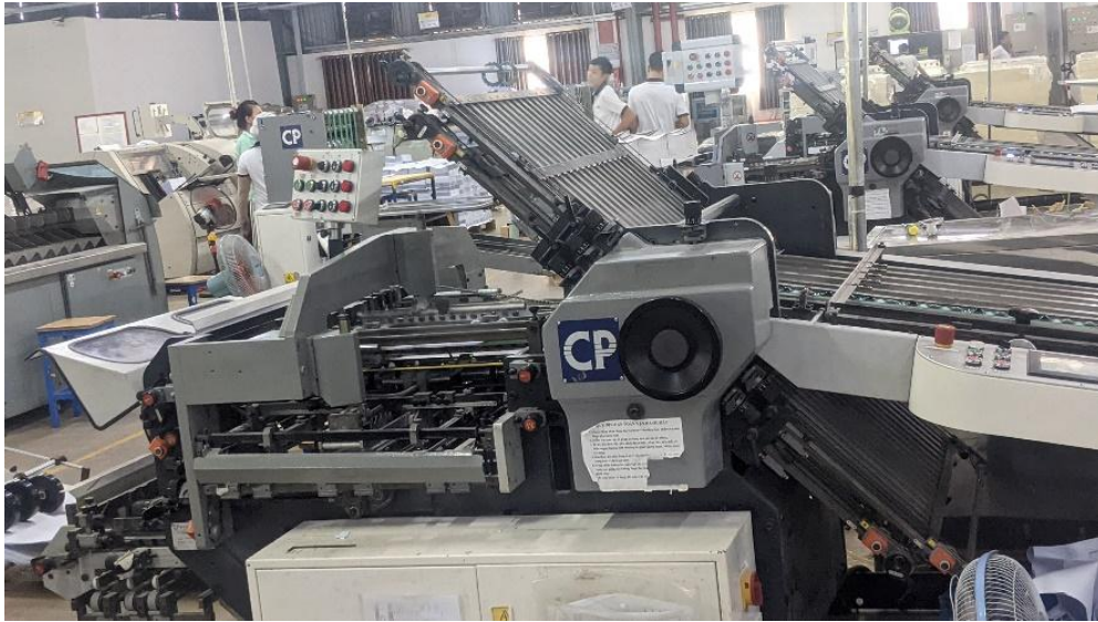
Hình 1. 7. Hình ảnh tại công đoạn gấp giấy trong quy trình sản xuất tờ gấp
