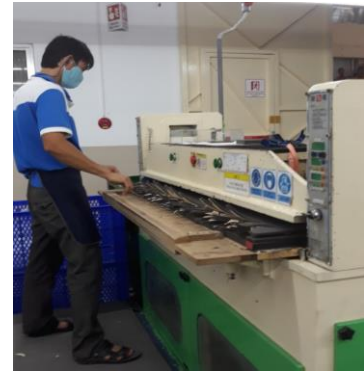
Công đoạn dập
